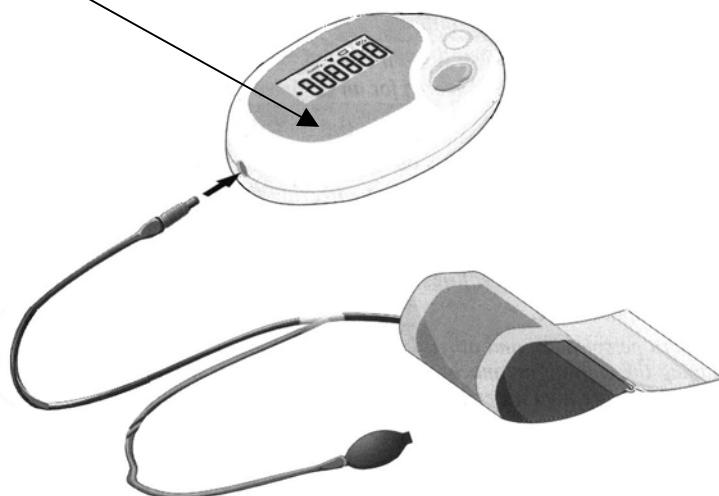
Slika 1: Izgled tlakomjera za krvni tlak tip DS 132 s prikazom mjesta za smještaj ovjerne naljepnice
